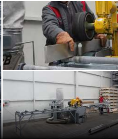
Usluga brušenja inox flahova, kvadratnih i pravougaonih cijevi max. dimenzija 120x120 mm
